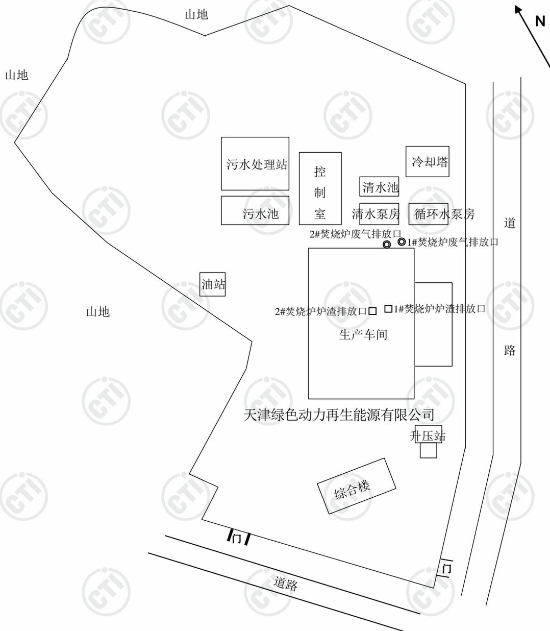
说明：◎焚烧炉废气检测点
